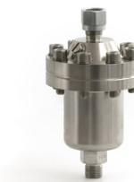
Разделитель сред «жидкость/газ» РПГ предназначен для проведения калибровок и поверок средств измерения давления, не допускающих попадания внутрь жидкости (в том числе пищевого исполнения, кислородного исполнения, специального исполнения). Разделитель устанавливается непосредственно на гидравлическое устройство, требует подключения к источнику питания (баллон сжатого газа или компрессор). Максимальное давление 25 МПа.
