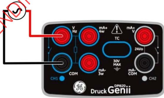
Рисунок 2-12. Измерение напряжения перем. тока или мВ перем. тока на CH1. Диапазон ±20 среднеквадратических вольт
