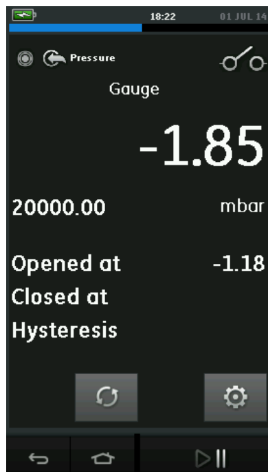
Рис. 2-15. Пример тестирования переключателя
