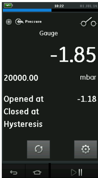
Рис. 2-13 Пример испытания переключателя
