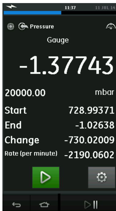
Рис. 2-25 Пример испытания на герметичность
